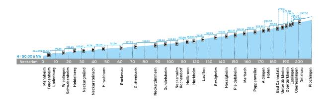
Die Abmessungen der 27 Schleusen definieren die Größe der auf dem Neckar fahrenden Schiffe. Jede Schleusenkammer ist 110 Meter lang und 12 Meter breit, davon sind zirka 105 Meter Länge und 11,45 Meter Breite nutzbar. Um den Neckar für lange Schiffe befahrbar zu machen, wird an jeder Schleuse je eine Kammer entsprechend vergrößert.
